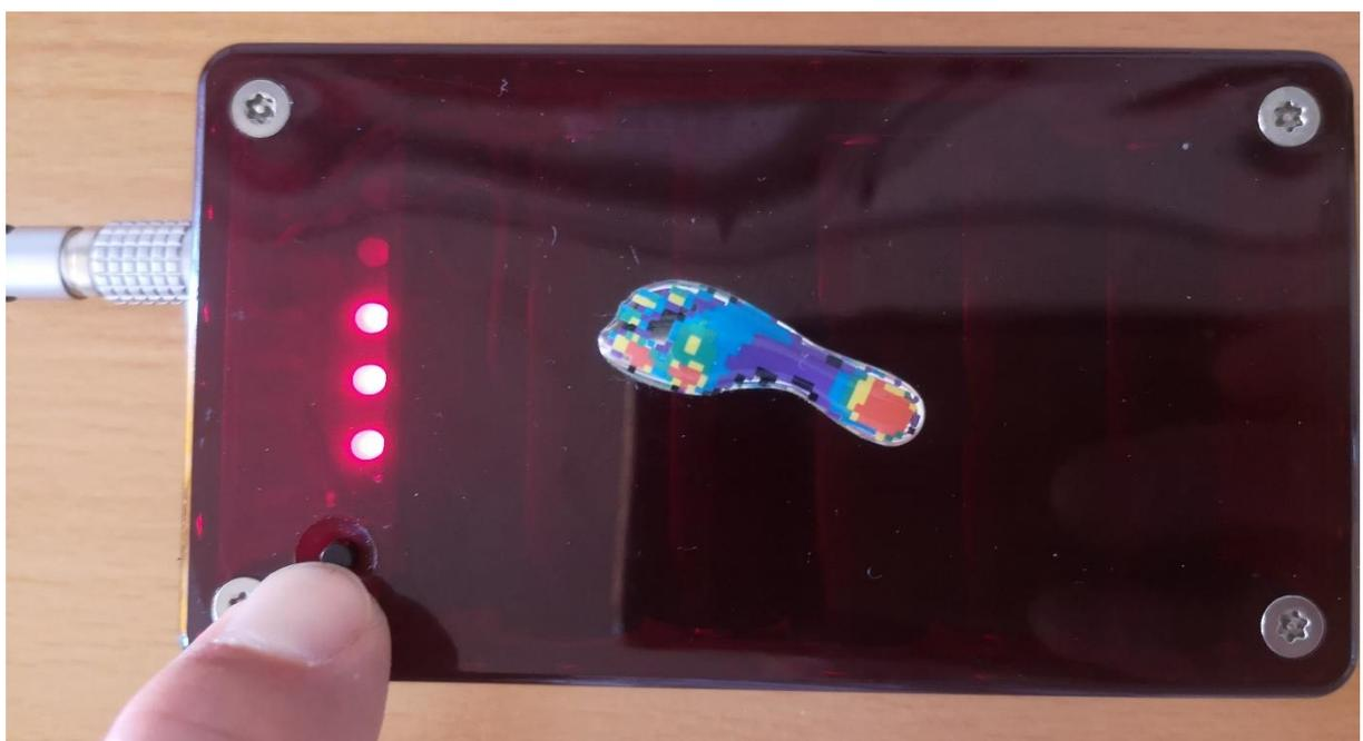
5. Novel Sender mit Messmattenkabel und Matte verbinden
