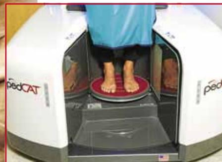
▲ **DURCHBLICK** Ein spezielles Gerät röntgt den Fuß im Stehen dreidimensional. Die Ergebnisse sind so genauer
